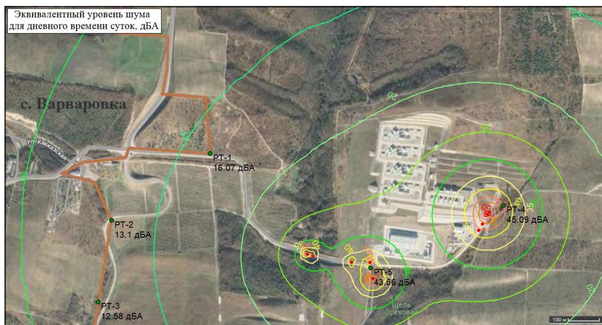
Рисунок 7.6-2 Графические результаты моделирования зон воздействия максимального уровня шума от работы оборудования для дневного времени суток (дБА), шаг сетки 20 м
