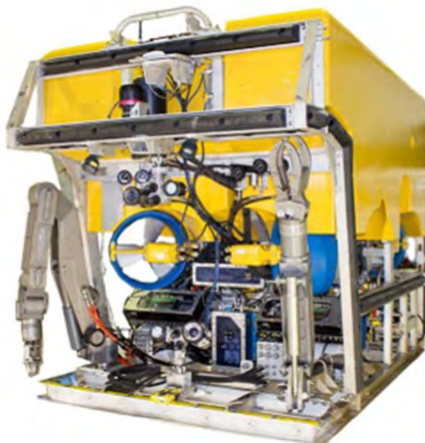
Рисунок 5.1-3 Телеуправляемый необитаемый подводный аппарат рабочего класса Perry Slingsby Triton XLR 125 HP
