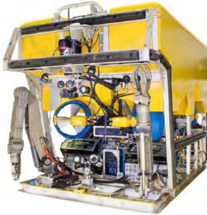
Рисунок 6 – Телеуправляемый необитаемый подводный аппарат рабочего класса Perry Slingsby Triton XLR 125 HP
