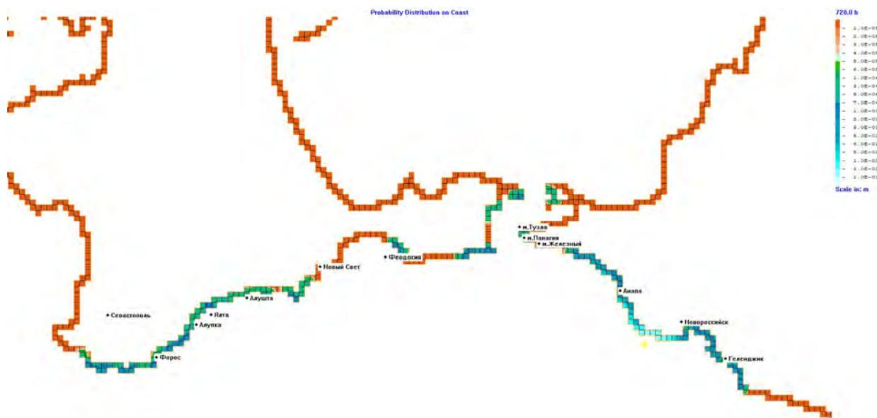
Рис. 7.1.11. Вероятность попадания разлива ДТ в различные области акватории через 720 час распространения.
