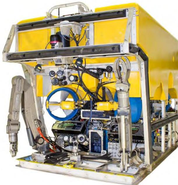
Рисунок 3-2: Телеуправляемый необитаемый подводный аппарат рабочего класса Perry Slingsby Triton XLR 125 HP
