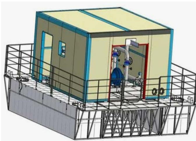
Рисунок 2.3-1. Плавучая насосная станция ПНС 300-120
