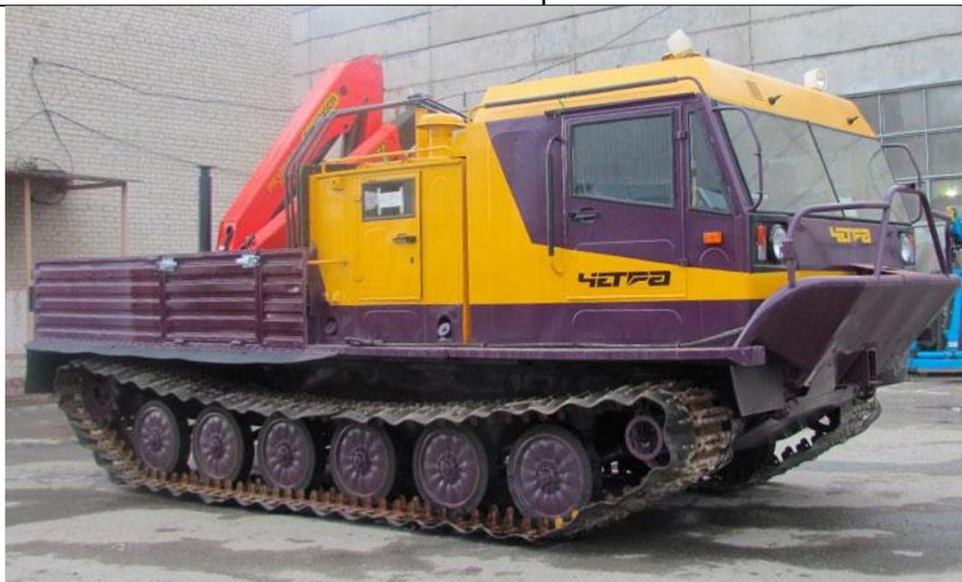
Рисунок 7 – Вездеход ТМ-140 с грузоподъемным краном-манипулятором
